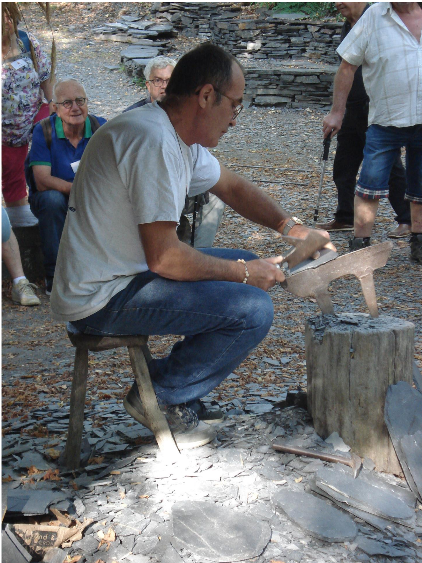
Le façonnage de l'ardoise
