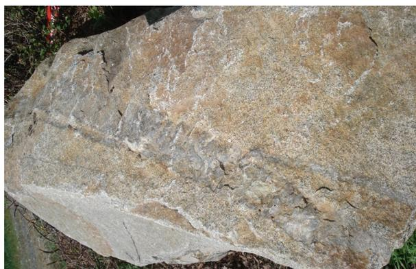
**Filon de quartz laiteux dans un bloc de granite (carrière « Roche bleue »)**
