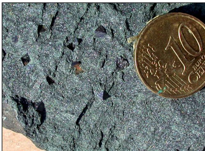
▲ Echantillons de chloritite contenant des cristaux de magnétite
