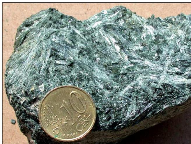
▲ Echantillon de serpentinite avec trémolite fibreuse
