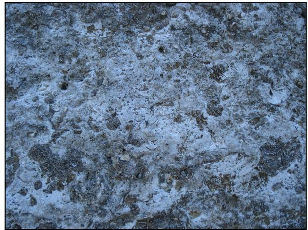
**Détail de la photo précédente montrant l'importance de la fraction bioclastique**
