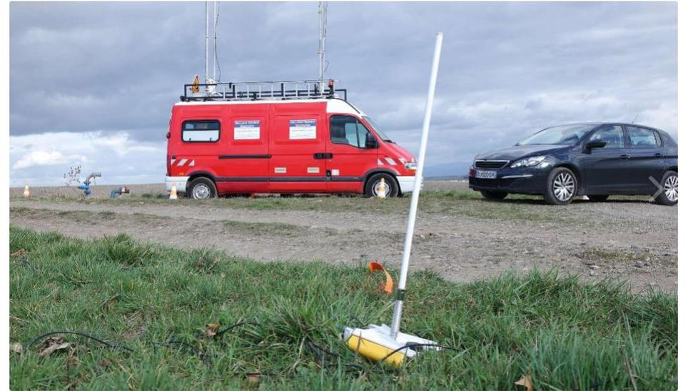
**Le camion « labo » et un capteur relié au sol. C'est du labo que sont commandées les vibrations et où sont réceptionnées les informations.**
