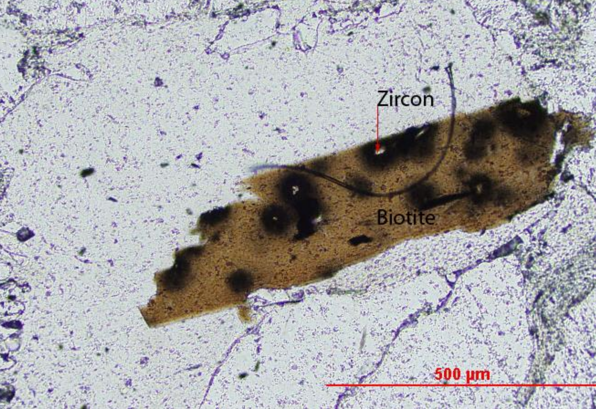
Inclusions de zircon dans un cristal de biotite
