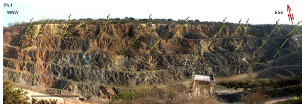
Photo 1 - Panoramique de la carrière de Vairé - Structuration en prismes hectométriques pentés de 30° vers l'est
