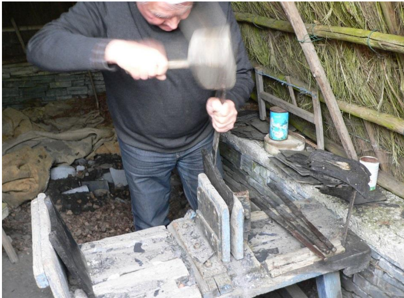
La fente ou fendage – Le « reparton » est divisé en une vingtaine de « fendis »
