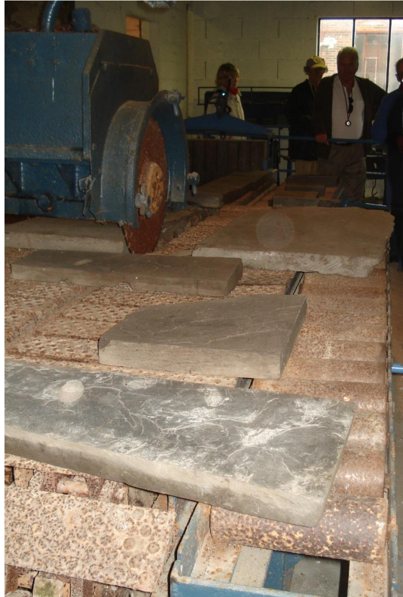
Machine à repartonner - « Quernage » du bloc d'ardoise en « repartons »
