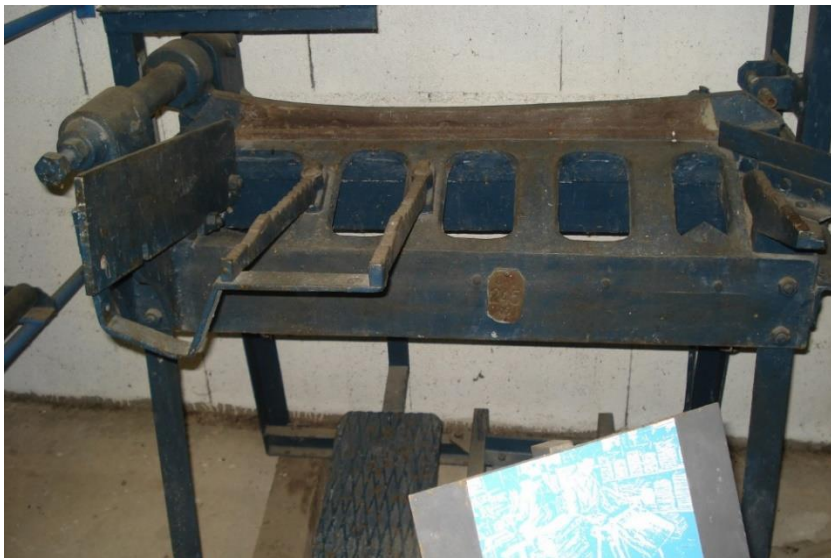
Etabli « moderne » de fendage et de rondissage
