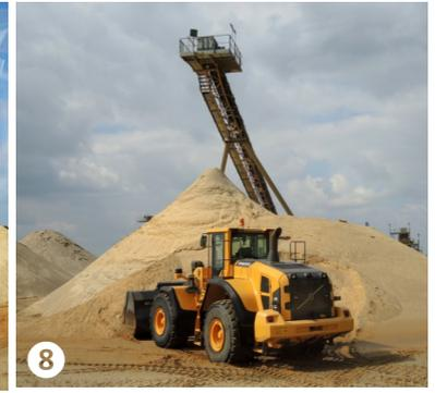
6 et 7. Stockage en tas de sables de différentes granulométries avec tapis élévateurs ("sauterelles") 8. Transport
