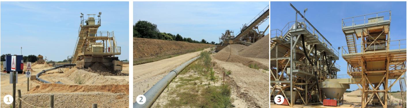
1. Extraction et trémie d'alimentation 2. Transport par canalisation d'eau de 40 cm de diamètre 3. Criblage et lavage
