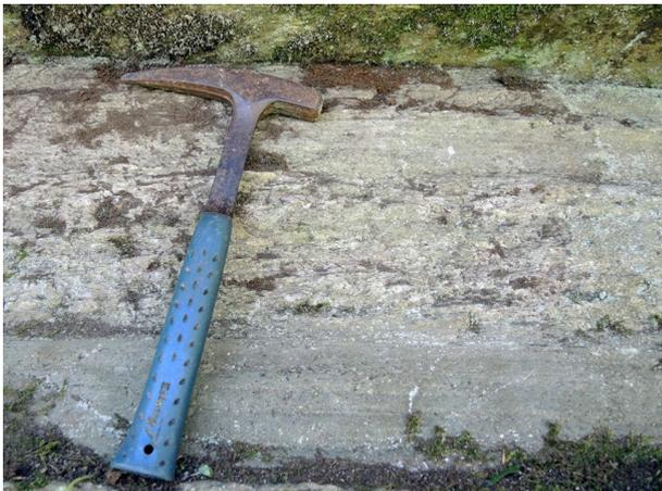
**Sur la hauteur du marteau, deux niveaux gréseux fins encadrent un niveau de poudingue.**
