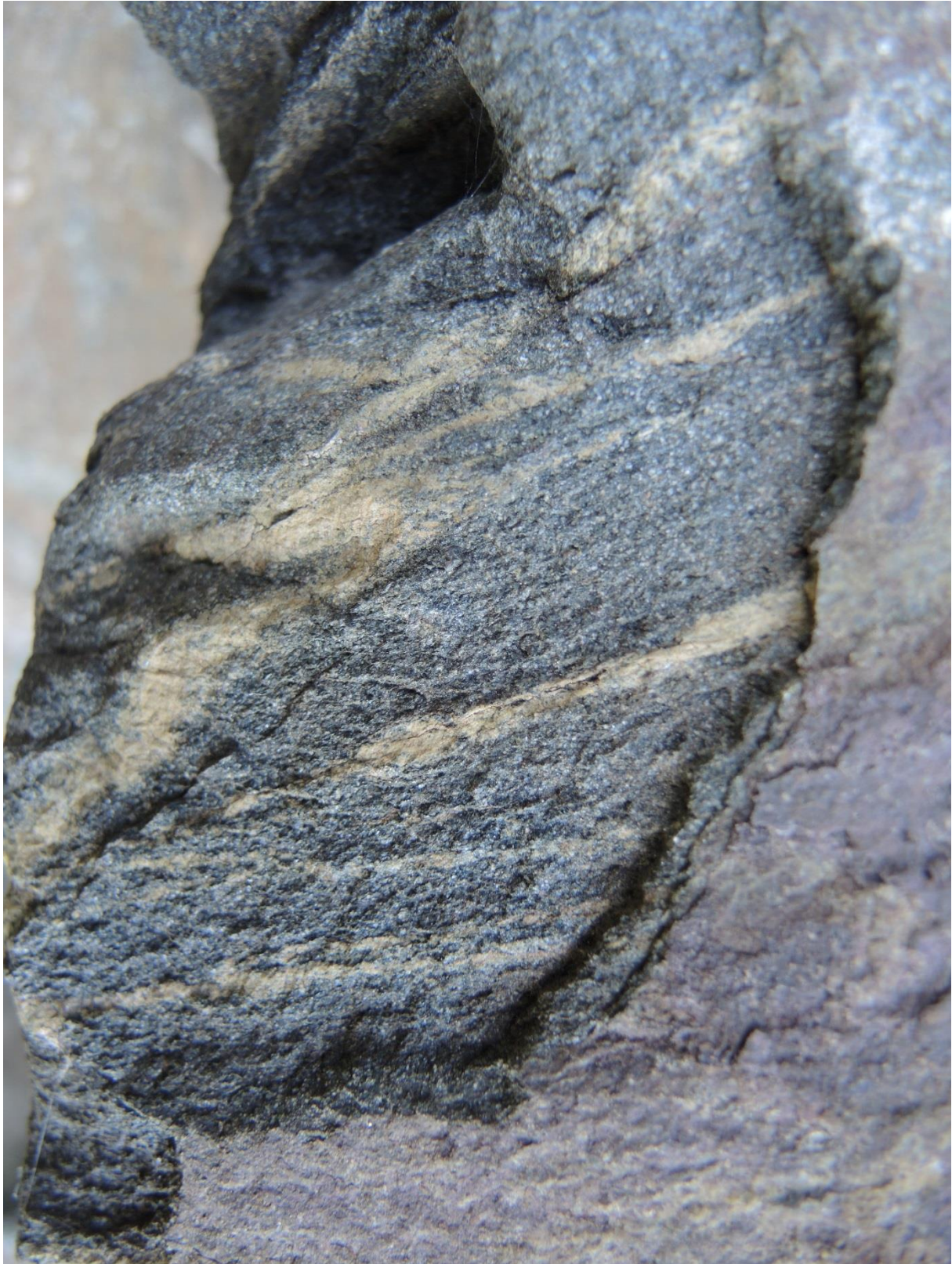
Microplis dans l'amphibolite, preuve que le protolithe de l'amphibolite a été plissé
