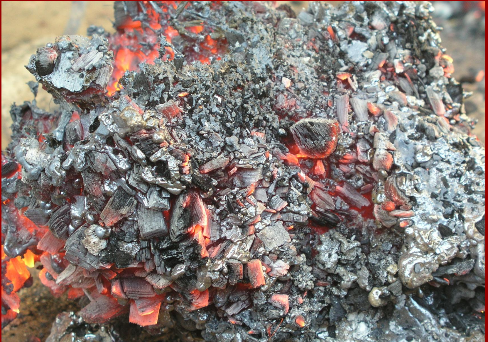
Le massiot est encore enrobé de braises de charbon de bois
