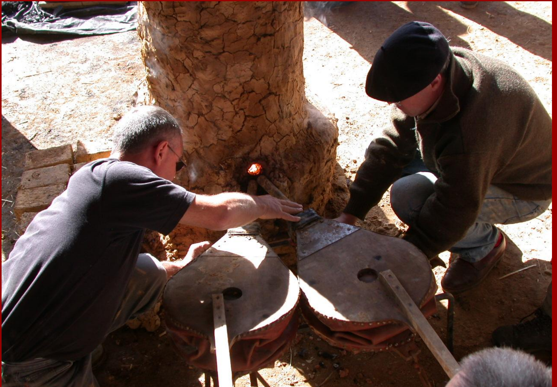
Connexion des deux soufflets à la tuyère haute
