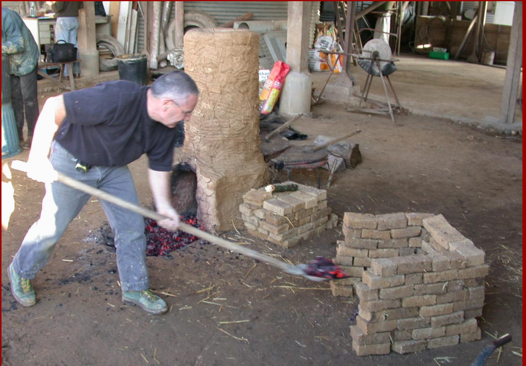
Les braises sont enlevées pour fermer le four et mises en réserve
