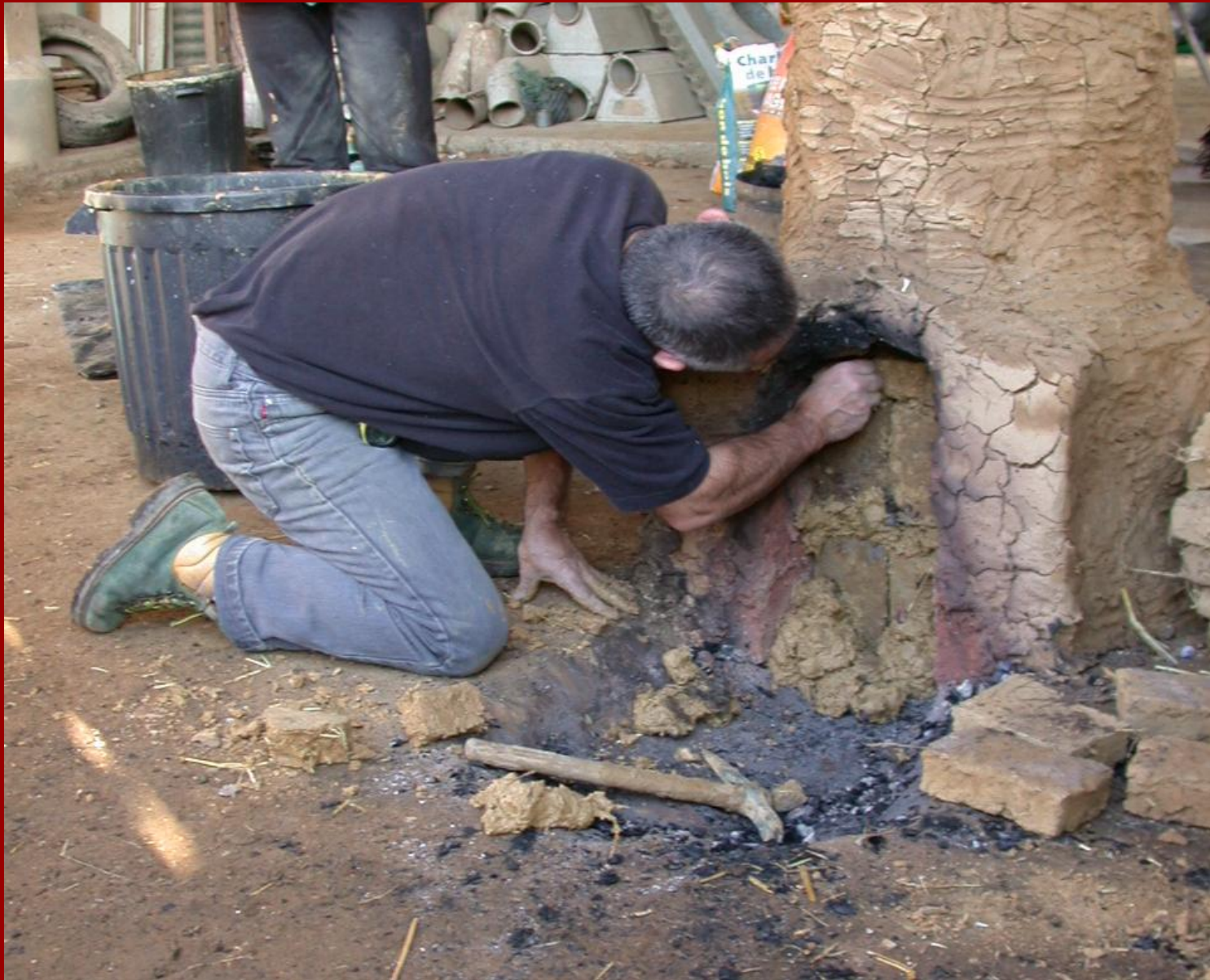
Fermeture de la porte du four avec des briques et de l'argile
