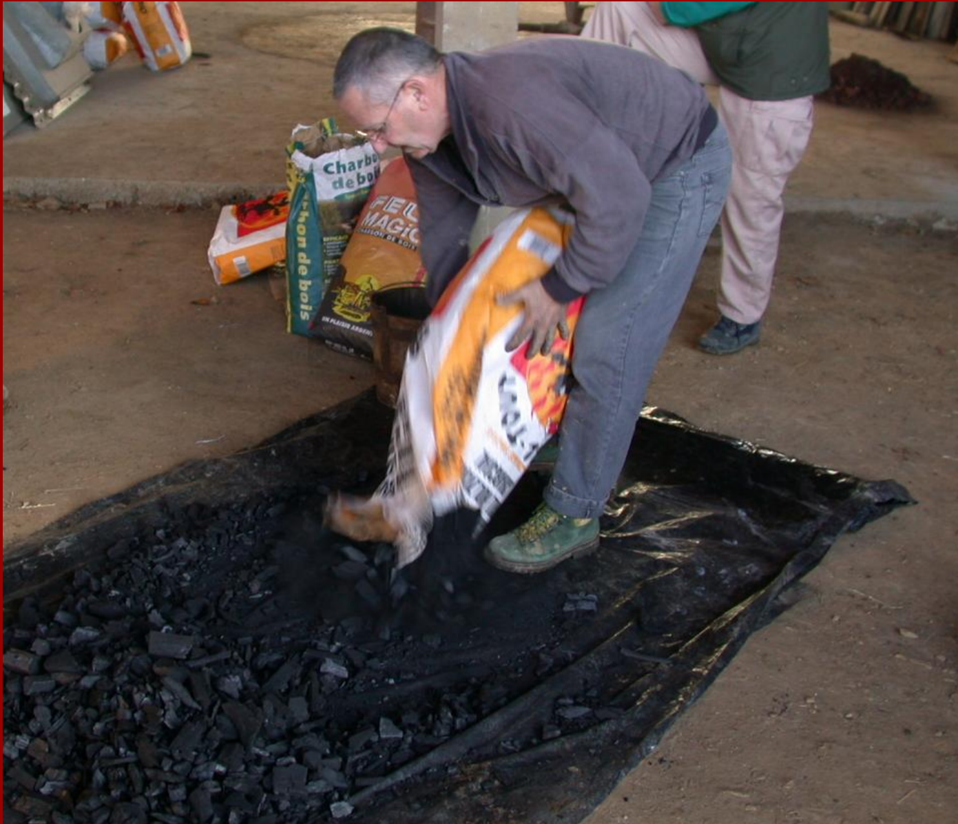
Préparation du charbon de bois pour alimenter le bas-fourneau
