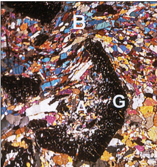
Fig. Structures de déformation dans l'éclogite au MP G : grenat creux brisé lors de la déformation synéclogitique; A : Omphacite protégée de la déformation par le grenat; B : Omphacite foliée à gros grains dont la foliation tourne autour du grenat; D'après GODART [1988] , ROERMUND [1995] , MAULER [2001]
